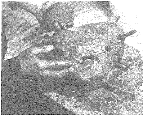
⑨型の周囲と、縛った針金を荒土で覆い隠す。(塗り込めという)ガス抜き用のパイプ及び、色見の穴を塞がないように注意する。同時に湯口の周囲を荒土で囲い、鋳型が完成する。
