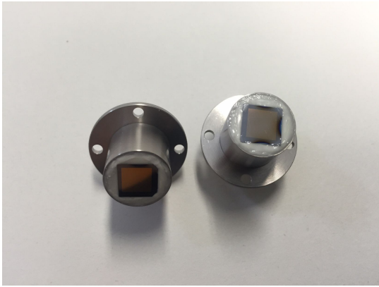
図6 メタマテリアル超音波振動子の外観。シリコン基板の表面には図3に示した様なスプリットリングとバーを組合せた構造が金蒸着されている。裏面には圧電体 ZnO トランスジューサーが塗布されている。
