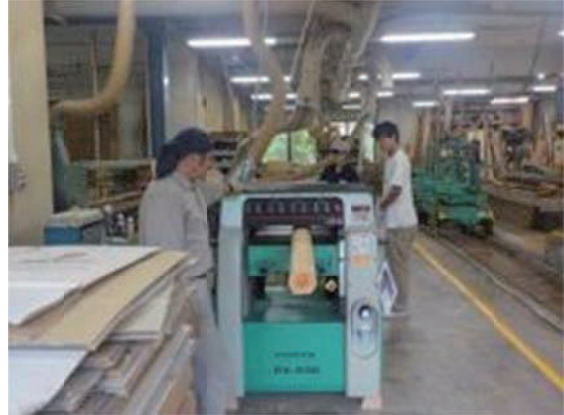
図-24 自動カンナ盤を使った木材切削作業
