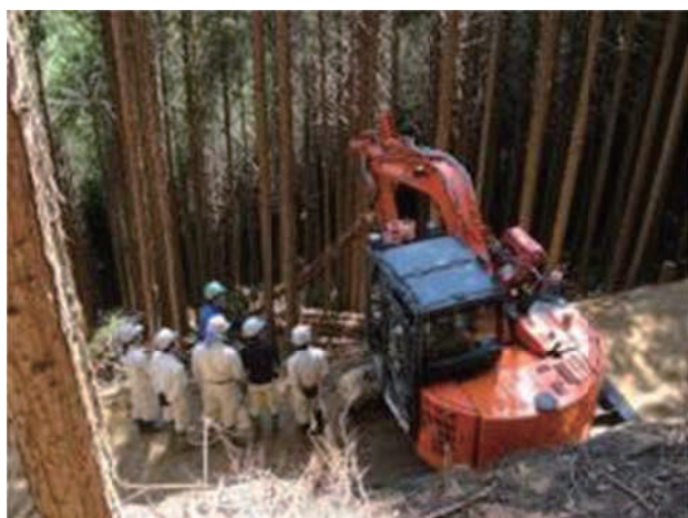
図-38 スイングヤーダによる集材作業
