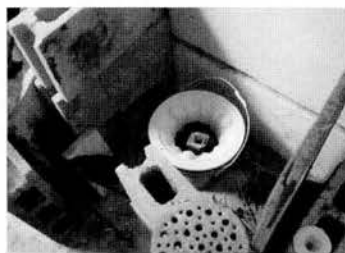
写真15 七輪の底に鑄型を置く 台を設置
