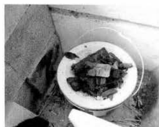
写真16 鑄型を入れた後、木炭を 被せる
