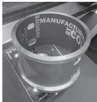
図5 国際溶射会議に展示されたコールドスプレーによるステンレス鋼ハウジング部材(外径約40cm、ステンレス鋼430L、成膜速度10kg/h、付着率94%以上、成膜質量60kg、加工後54kg 18) )
