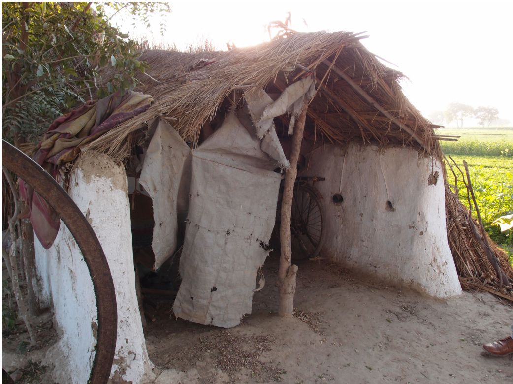
インドの作業小屋（インド IND [マオリ、マツラ]）2017 壁は、牛糞を材料としている。
