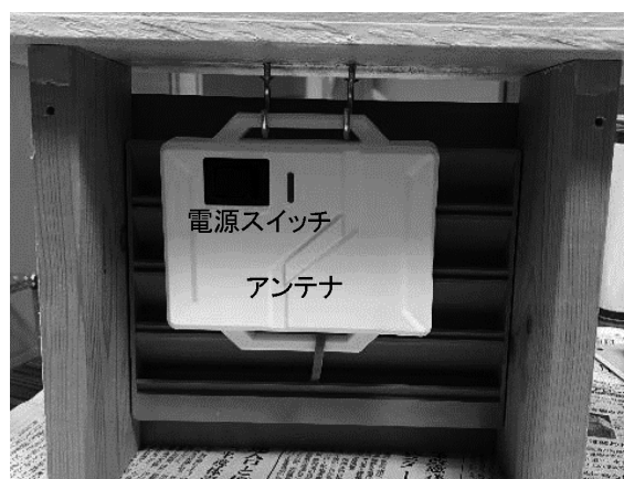
写真1. LPWA（LoRaWAN）モジュールを搭載した温度センサー。筐体は IP67 相当の防水・防塵性能、リチウムイオン乾電池（3 V）で駆動。
