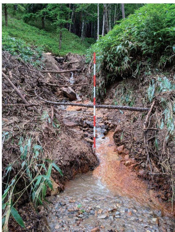
写真5 南側溪流の侵食と基岩（花崗閃緑岩）の露出（作業道～観測地点 No.2 の区間）
