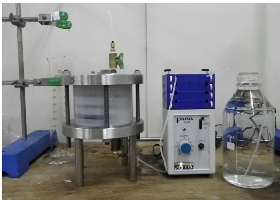
図 3-4 塩水淡水置換の室内トレーサー試験の実施状況
