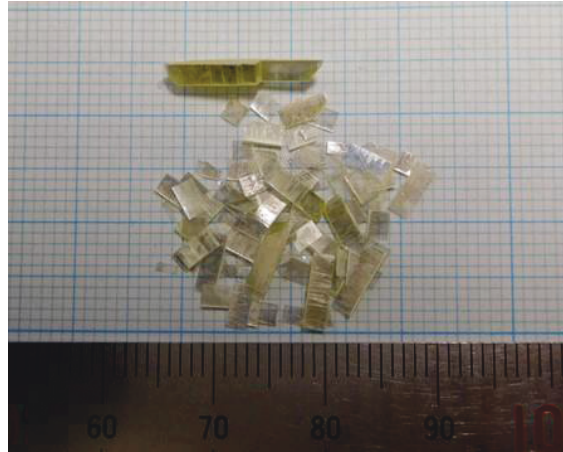
図 2-3 \{100\} と \{001\} 面で劈開して短冊状に割れた \beta\text{-Ga}_2\text{O}_3 結晶
