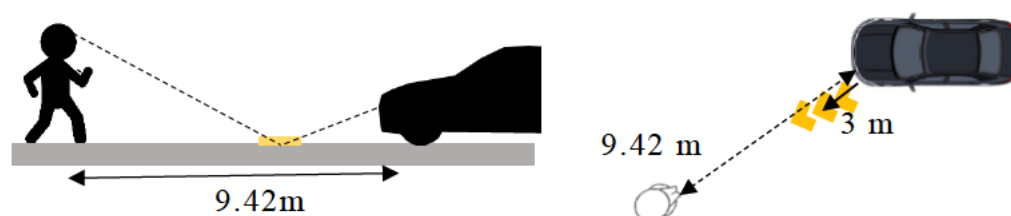
図 2-31： 路面描画ランプの不快グレアが最も懸念されるレイアウト（左：側面視，右：上面視）
