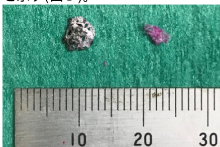
図2. コラーゲンに混入後、凍結乾燥させた膨張黒鉛(左)と凍結乾燥させたコラーゲン。
