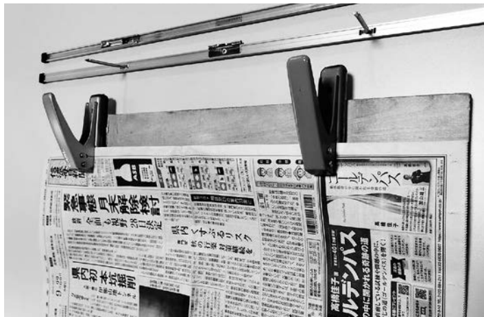
写真2. 1つ穴2台を使った新聞用穴あけパンチ (自作) 台の端に合わせて使う
