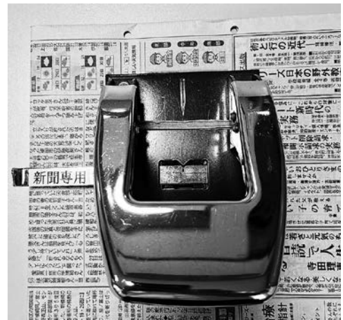
写真3. 市販品を改造した新聞用穴あけパンチ 4穴ができるが、そのうちの2穴を使う
