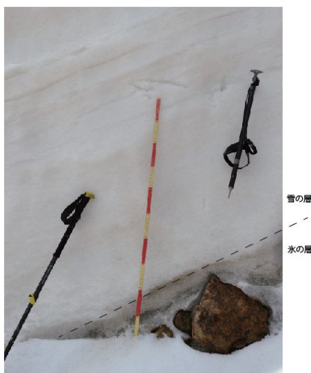
図3 破断面底部の水の層。破断面最上部からやや斜面下方の標高2950 m 地点（図7 積雪層厚測定位置）。2019年6月13日撮影。
