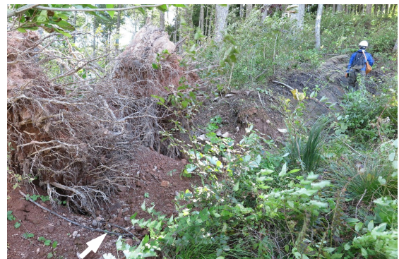
12-1-2 斜面の西側上昇に伴う撓曲と倒木の連続
