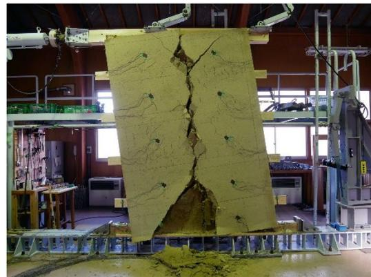
写真 2 試験体 4 最大変形時 (1/7.2rad)
