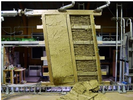
写真 1 試験体 2 最大変形時 (1/8.4rad)
