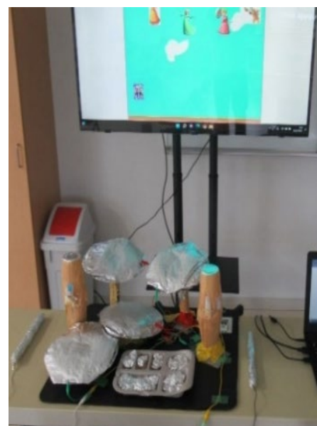
図2 (左)Scratch で組んだプログラム例. (右)Scratch と KeyTouch が連動するコントローラーの例
