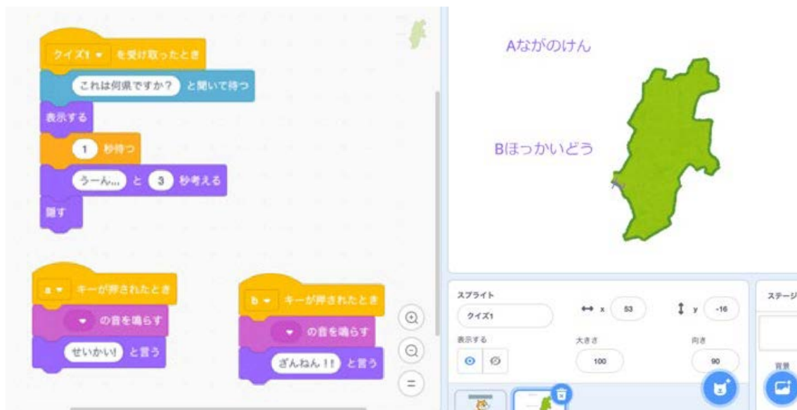
図1 スクラッチで作成したクイズのプログラミングの例
