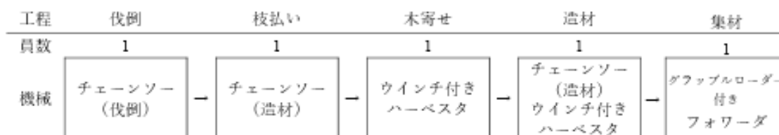
図 2-2 終伐の作業システム
