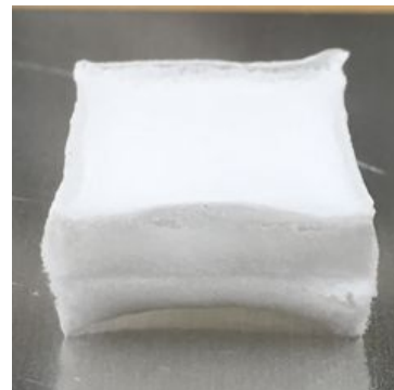
図2. キチンナノファイバーの自己凝集を利用して作製したブロック状の材料
