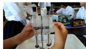
図 2 H 管に集まった気体を冷やす C 生の班の実験の様子
