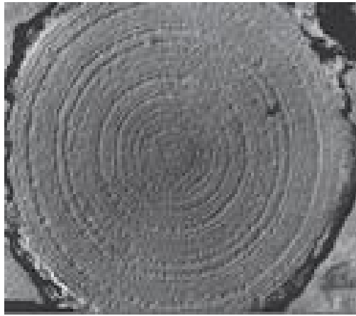
図 2.3 カルボニル鉄粉の断面構造 [2]
