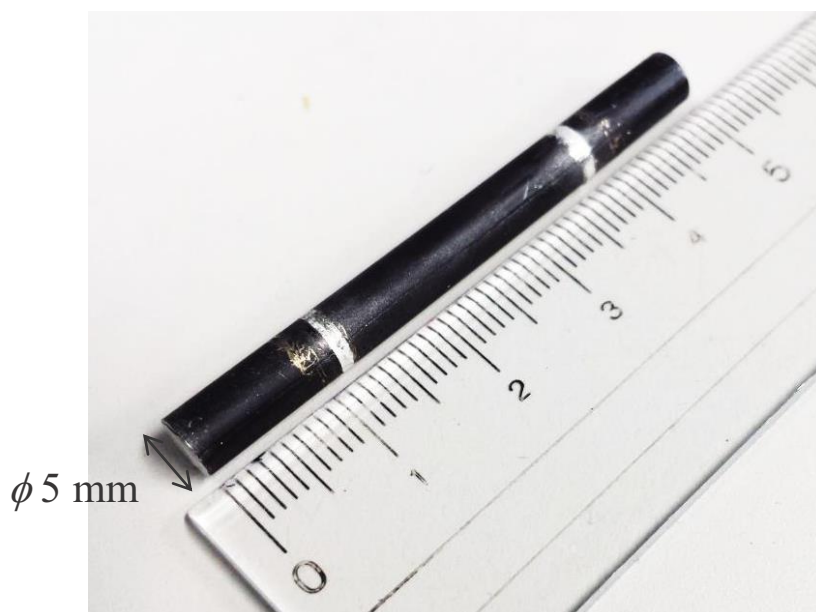
図 3.19 体積抵抗率測定用試料
