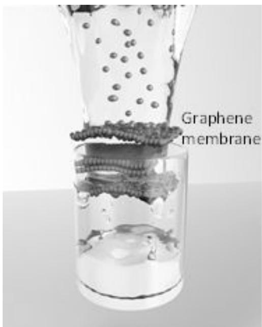
図 1 グラフェン/酸化グラフェン複合膜を使用した海水淡水化膜の概念図。グラフェンエッジ構造で構成された細孔の効果により、最高で 96%の塩分を除去できた。
