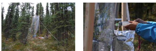
図 5: ^{13}\text{C}_2 ラベリング チャンバーにて樹冠を覆い(左図) 99.9% ^{13}\text{CO}_2 を注入(右図)
