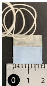
図 2 本研究で用いた光燃料電池のチタニアアノードの写真
