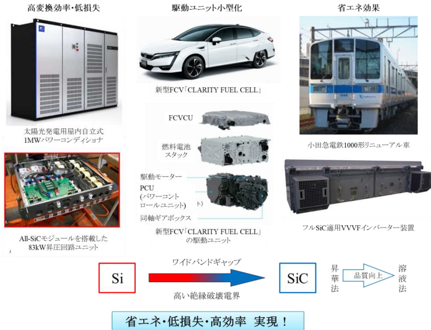
図 1.2 SiC パワーデバイスの実用化 [4, 5, 7]
