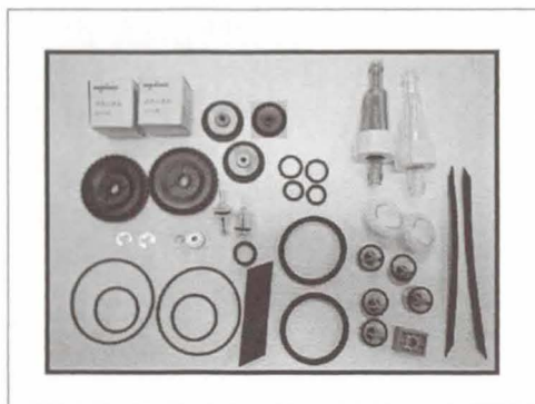
図1 DCG-03のオーバーホールに使用する部品
